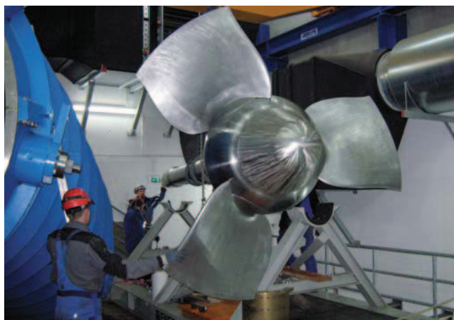
Mise en place de l'arbre d'entraînement.
